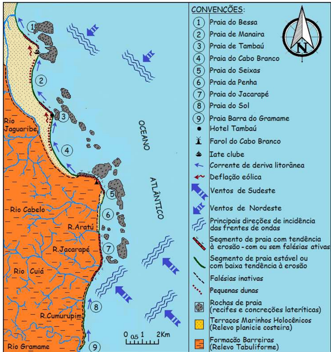
Figura 03 – Esboço temático com localização das praias, informações geológicas, geomorfológicas e processos costeiros associados.
