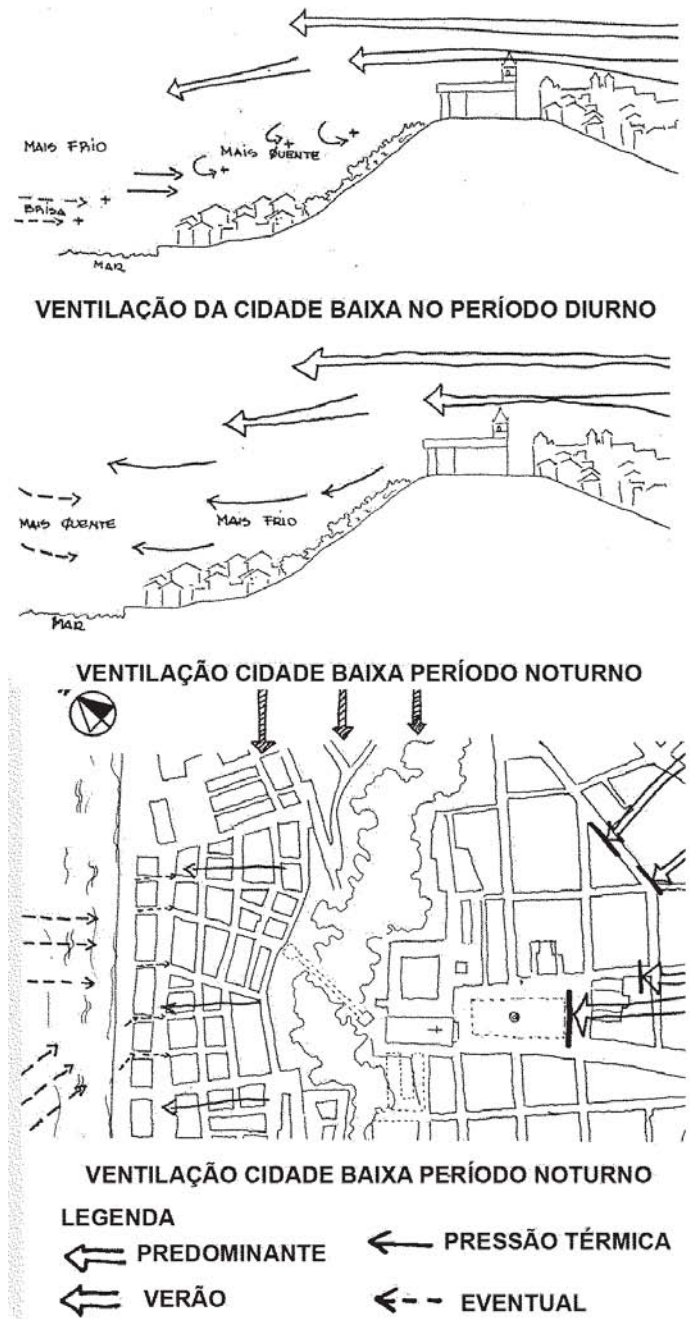
Figura 4 – Esquema da ventilação na Cidade Baixa o período noturno. Fonte: Klüppel, 1991, s/n.
