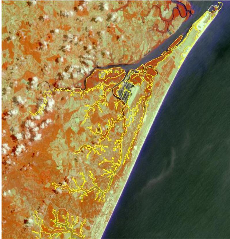
Na presente imagem, é possível visualizar contrastes na variação de cor vermelha, com a aplicação do NDVI, que se refere a quantidade de vegetação naquele local específico. A variação de tons avermelhados permite indicar as áreas com maior concentração de flora. Nota-se também, estruturas de prédios na região norte da APA, bem como regiões desmatadas e com pouca vegetação, que são as áreas em branco, bege e cinza. As linhas amarelas delineiam a ZPR, na qual não é permitida nenhuma alteração.
