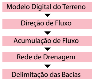
Figura 2 – Esquema do Pré-processamento do Terreno
