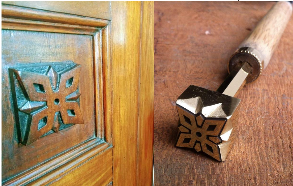
Figura 11 - À direita, detalhe em madeira da porta de entrada do salão de leitura da Seção de Obras Raras da Biblioteca de Manguinhos e à esquerda ferro de douração para aplicação de florão sendo confeccionado em alusão ao referido detalhe da porta.
