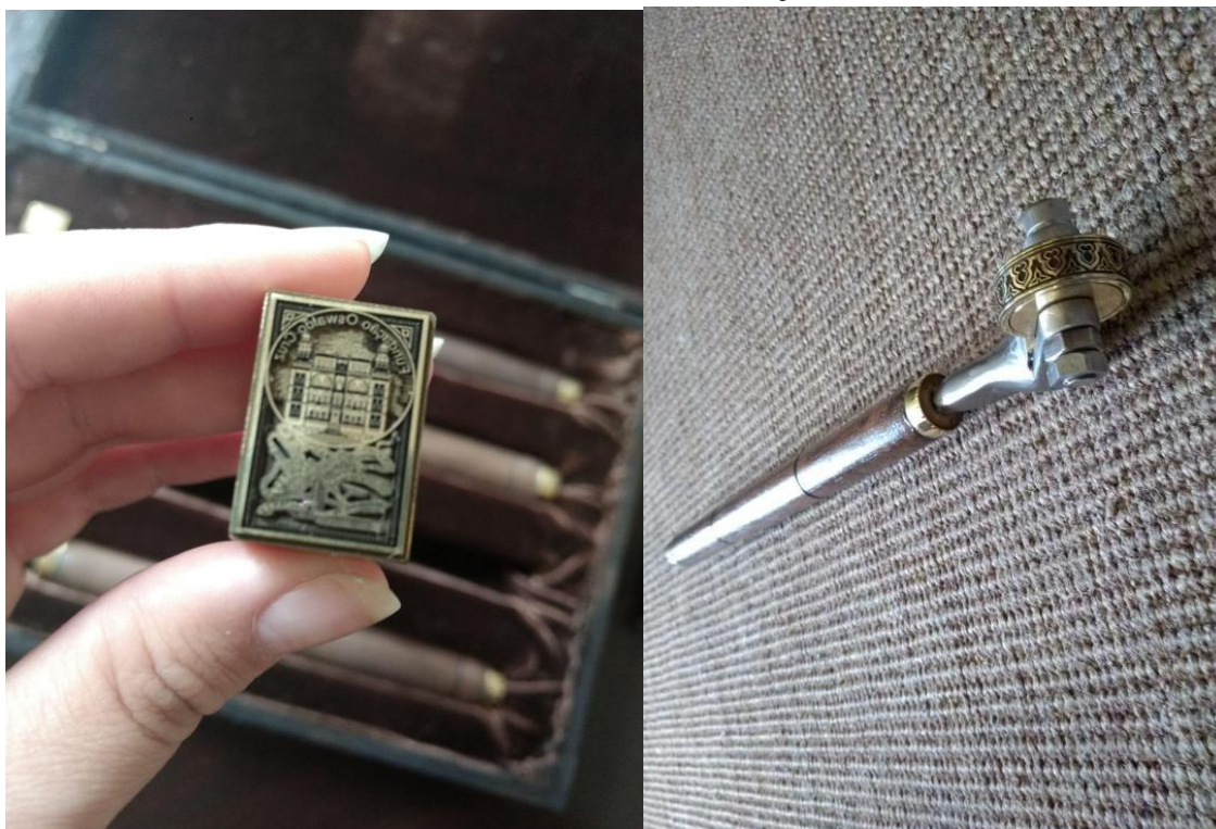
Figura 10 - À esquerda, ferro para douração de super-libros e à direita roda para aplicação de friso mourisco às encadernações.
