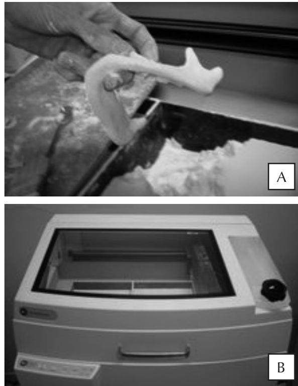
Figura 4 (a,b): Máquina de PR (a) e remoção do biomodelo recém-plotado do equipamento (b)
