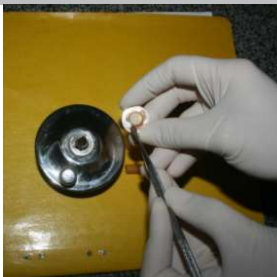
Figura 2. Fixação da amostra no disco de acrílico com cera pegajosa.
