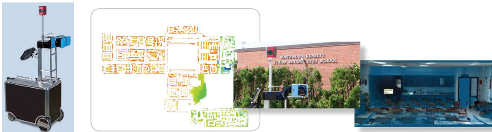
Figura 4: (a) Sistema TIMMS; (b) Vista em planta da nuvem de pontos na escola Northwood-Kensett High School; (c) Foto do exterior da escola; (d) Nuvem de pontos com textura aplicada no interior de uma sala de aula.
