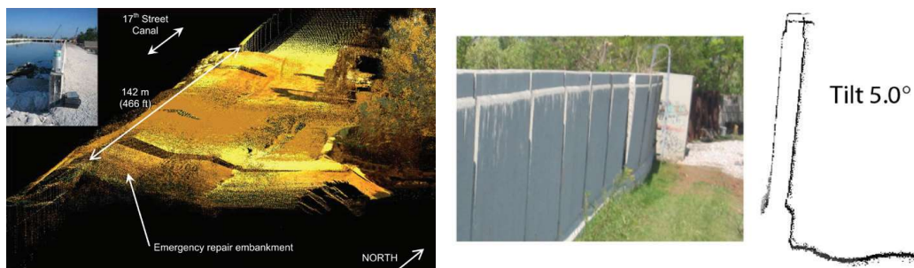
Figura 10: (a) Medições e anotações sobre nuvem de pontos de um trecho de Nova Orleans; (b) Detalhe de uma estrutura abalada (inclinada em 5 graus) pelo furacão. Fonte: Seed et al., 2006.
