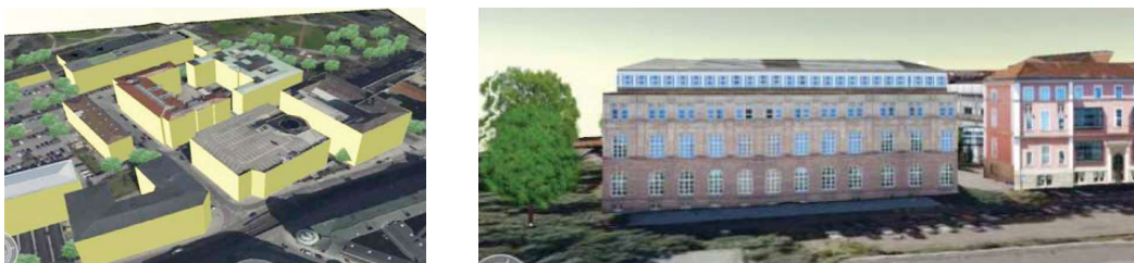
Figura 9: Modelo geométrico do campus da Universidade de Stuttgart: (a) sem a textura real; (b) com texturas capturadas das coberturas e das fachadas (imageamento por satélite e tomadas terrestres, respectivamente).
