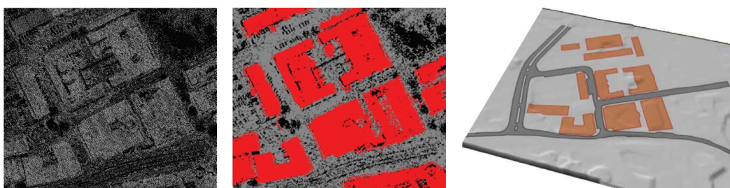
Figura 8: (a) Nuvem de pontos original - não classificada; (b) Nuvem de pontos classificada: terreno na cor cinza e edificações em vermelho; (c) Modelo Digital de Terreno e contorno das edificações.
