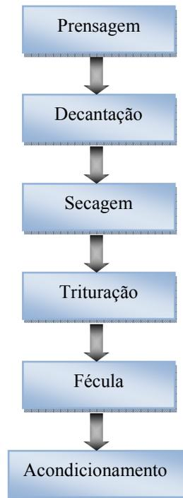
Figura 1: Fluxograma da extração da fécula de mandioca. Fonte: LIMA *et. al*, 2007 (adaptado).
