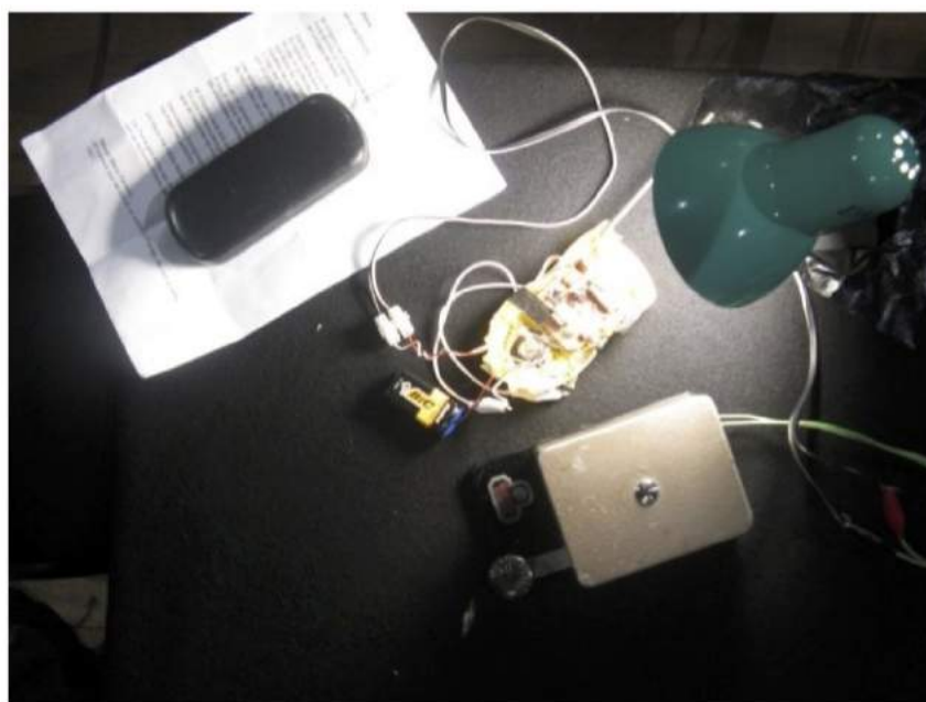
Walkie talkie intervenido como oscilador y transmisor de señales radiotelegráficas.
