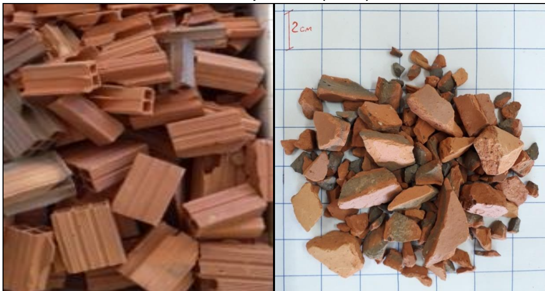
Figura 1: Imagens do RCV coletado nas indústrias de cerâmica (esquerda) e RCV triturado e peneirado (direita)
