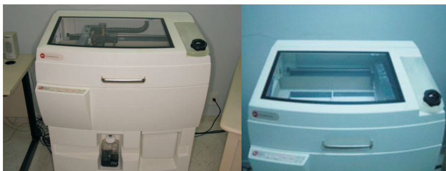
Figura 2 - Máquina de PR, presente no SENAI/CIMATEC-BA, onde os biomodelos foram confeccionados ( ZPrint-ZCORP ®)
