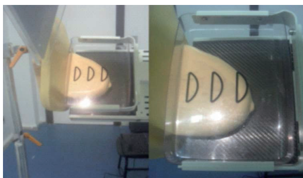
Figura 3 – Posicionamento MLO com vista do posicionamento do Mammo II Phantom RS 750 na pós-compressão
