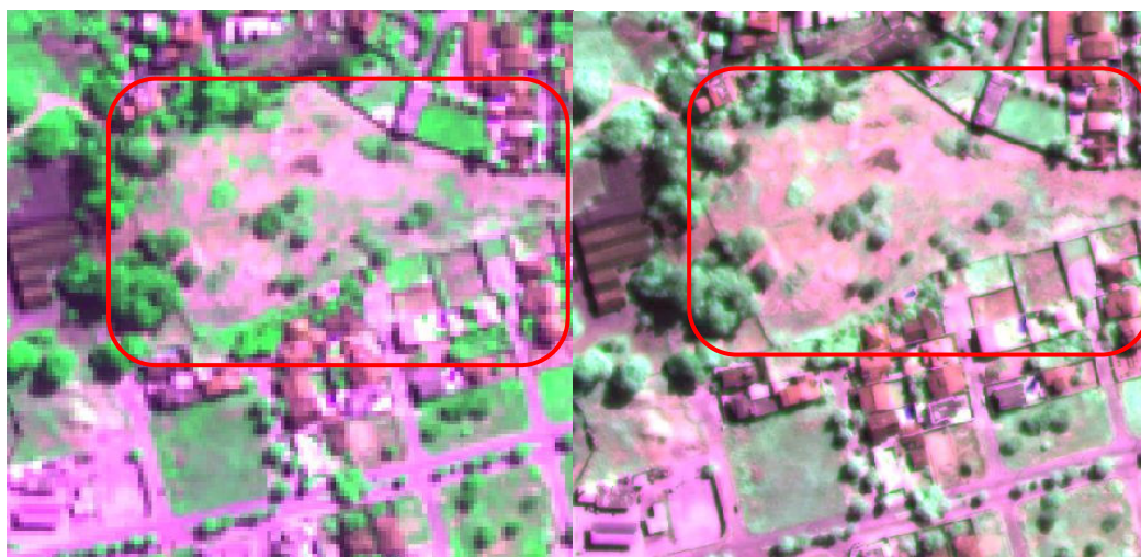
Figura 6. Subestimação do método BROVEY (resolução espacial de 0,6 m) quando comparado com a imagem de referência (resolução espacial de 2,4m).
