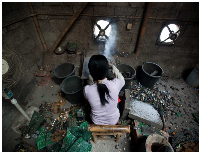
Figura 1. Trabalho artesanal de reciclagem de EEE (Disponível em: http://e-waste2011.blogspot.com.br )
