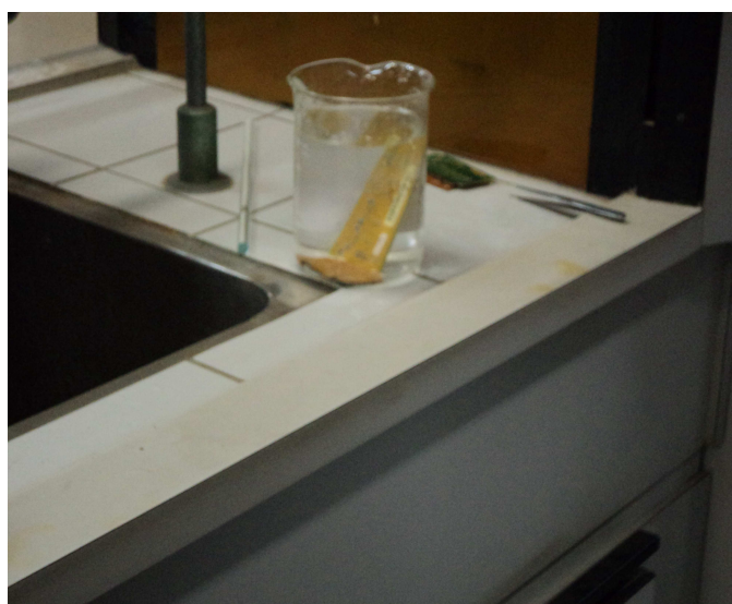
Figura 5: Placa de circuito impresso imersa em água régia
