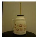
Figura 1 Calorímetro utilizado para determinação do calor liberado durante a reação de neutralização.
