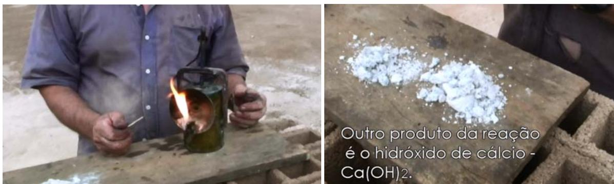
Figura 3a e 3b: a lanterna em funcionamento e um dos produtos da reação
