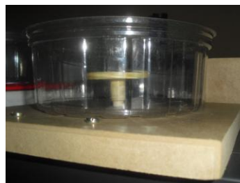
Figura 1. Spin-coater de baixo custo. Em primeiro plano, o suporte de amostras e o recipiente PET.
