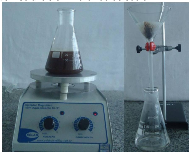
Figura 6: Digestão de alumínio para reciclagem
