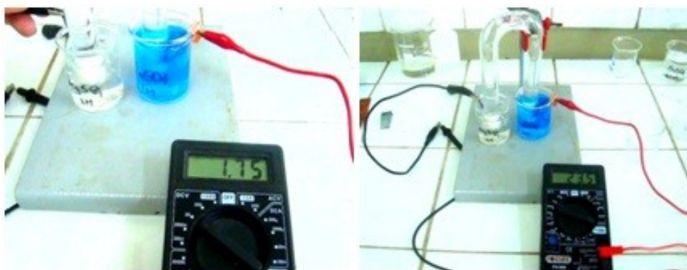
Figura 12: Pilha de Daniell de Cu/Mg - Sistema com multímetro – medição de Voltagem (1,75v) e de corrente elétrica (23.5 mA)
