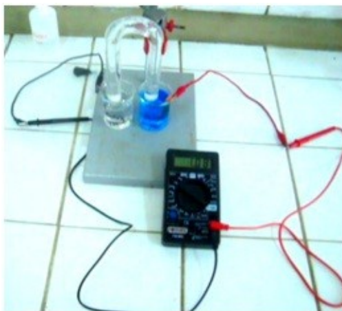
Figura 11: Pilha de Daniell de Cu/Zn - Sistema com multímetro – medição de voltagem (1,08V) e de corrente elétrica (13.2 mA)
