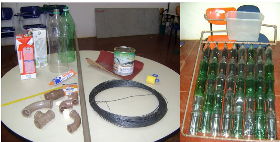
Figura 2 Montagem do aquecedor solar
