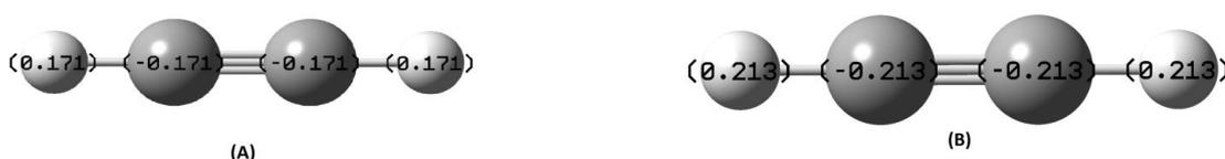
Figura 4: Cargas atômicas de Mulliken para a molécula do etino obtidas através do método DFT/B3LYP (A) e com o método Hartree-Fock (B), ambas com a base de Pople 6-311++G(d,p).
